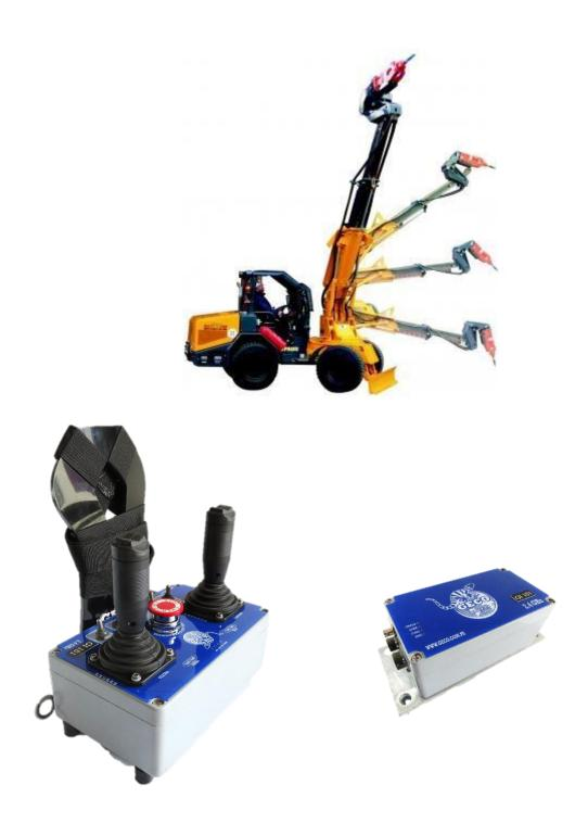
Control Remoto Geco inalámbrico en 2.4GHz, control proporcional del Scaler Paus con para operaciones altamente seguras.
